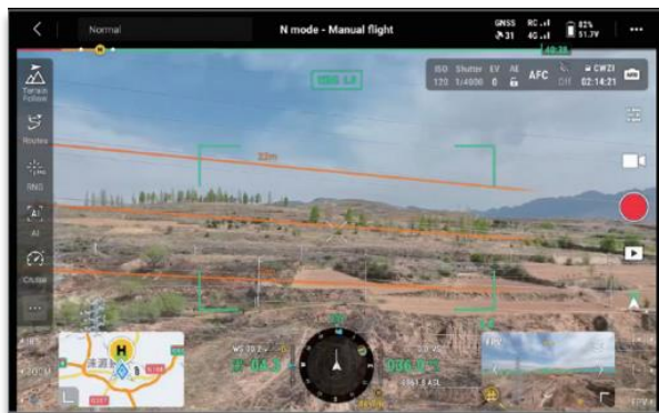
送電線レベルの障害物検知
