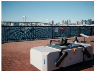
<ドローンポートの設置状況>
