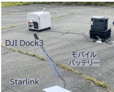
機体・通信・電源のシンプルな構成
